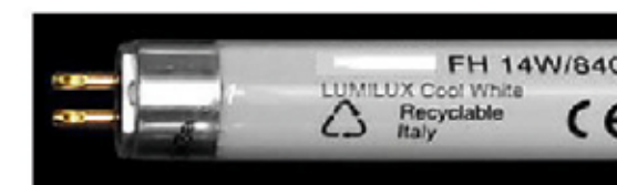
fluorescent avec un marquage 840 indiquant un IRC de 80 à 89 et une température de couleur de 4 000 K (blanc neutre)
